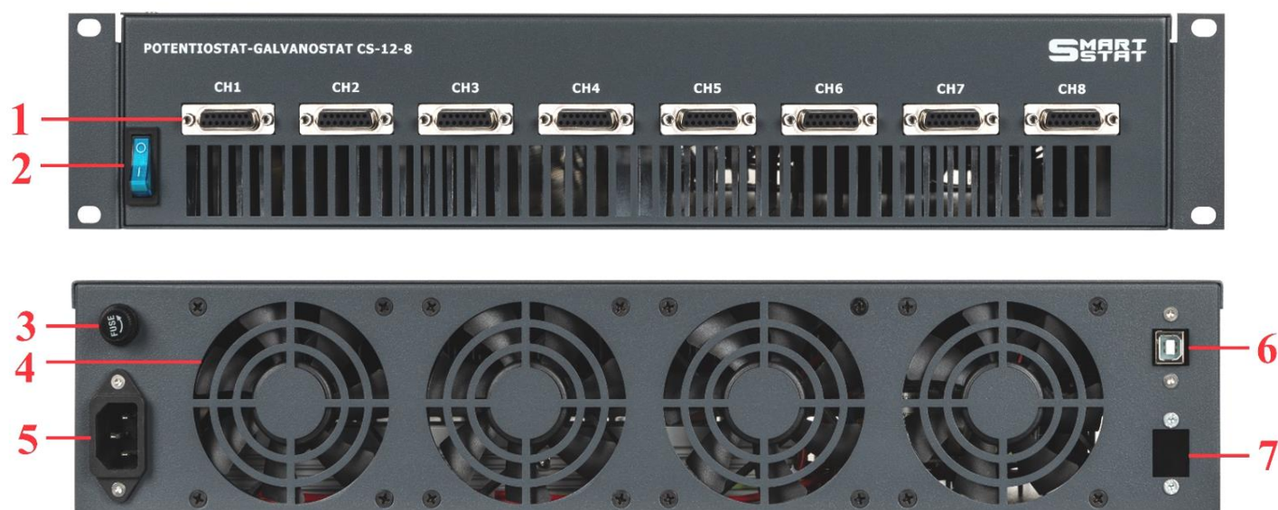
Рис. 3. Внешний вид потенциостата CS-12-8 индустриальной серии SmartStat: 1 – разъемы подключения электрохимической ячейки и экрана, 2 – тумблер включения с индикацией питания, 3 – гнездо предохранителя, 4 – вентиляторы охлаждения, 5 – разъем подключения кабеля питания 220 В, 6 – разъем подключения кабеля USB, 7 – окно для установки опций.
